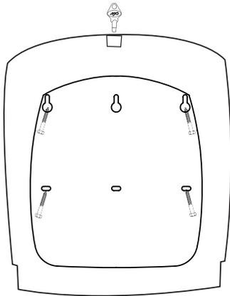
**1]** Öffnen Sie den Spender mit dem Schlüssel und montieren Sie ihn mit dem Schraubenset an der Wand. Die empfohlene Höhe liegt bei 125 cm über dem Boden.
