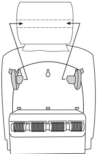
**2]** Die Papierrolle befestigen Sie mit den seitlichen Halterungen. **ACHTUNG!** Für die korrekte Anwendung, gehen Sie sicher, dass die Halterung der Rolle in die gleiche Richtung zeigt, wie das Label auf der unteren Hälfte des Spenders.
